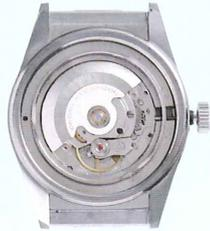
メンズ用の自動巻きムーブメント。サイズが25.6mmと小さく、より細かな分解掃除の技術と、繊細な取扱いが必要。
