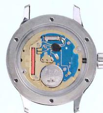
クォーツ式特有の32,768Hzで振動する水晶振動子を用いて高精度を実現。複雑な機構を要せず、シンプルなメカニズムを採用している。
