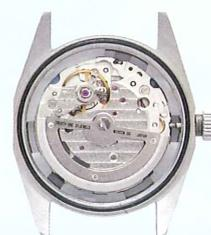
40年以上生産が続いていて、完成度が高く、世界に供給されている汎用自動巻きムーブメント。シンプルな構造と耐久性を誇る。
